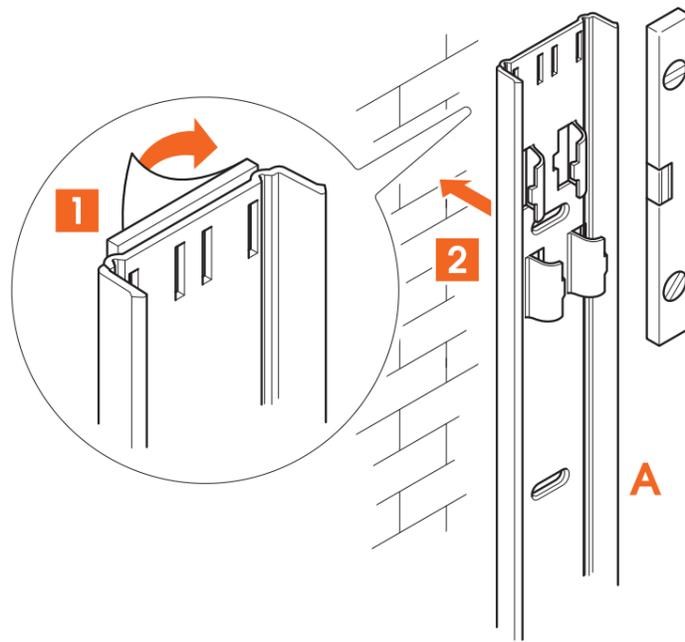
2. Kleben Sie die **Kabelkanalhalterung** ① an die Wand.
