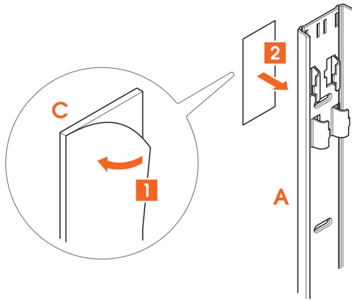
1. Kleben Sie das Klebeband auf die **Kabelkanalhalterung** ①.
