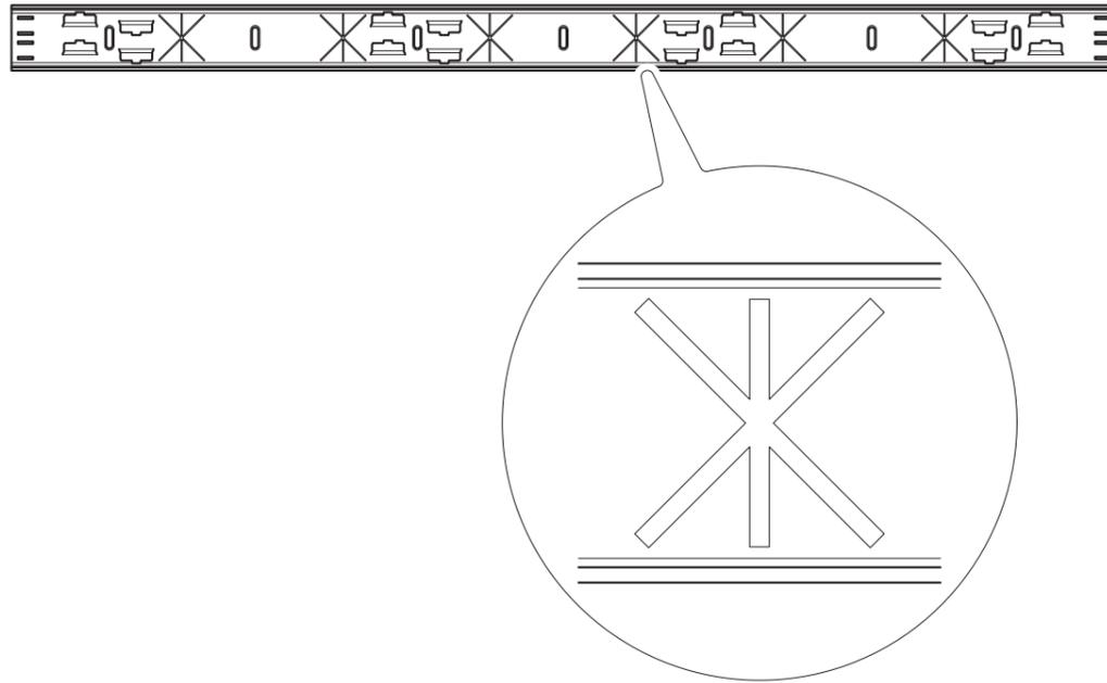
1. Schneiden Sie den Kabelkanal anhand der Markierungen auf die gewünschte Länge zu. Sie können ihn auch schräg abschneiden, um den Kabelkanal im rechten Winkel anzubringen.
