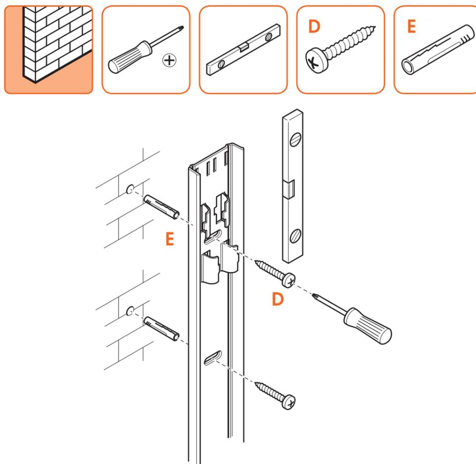
3. Befestigen Sie die **Kabelkanalhalterung** (A) mit den **Schrauben** (D) und **Dübeln** (E) an der Wand. Mit der Wasserwaage sorgen Sie für eine waagerechte Montage des Kabelkanals.
