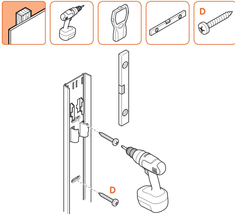
1. Befestigen Sie die **Kabelkanalhalterung** (A) mit den **Schrauben** (D) an der Wand. Mit der Wasserwaage sorgen Sie für eine waagerechte Montage des Kabelkanals.
