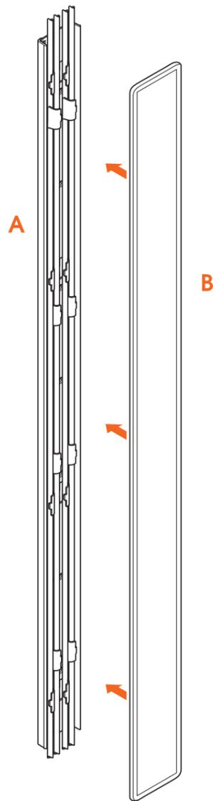
1. Bringen Sie die **Kabelkanalabdeckung** ② auf der **Kabelkanalhalterung** ① an.
