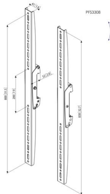
PFS 3308 ist für mittelgroße bis große Displays bis 80 kg Gewicht und einem max. vertikalen Passbereich von 800 mm geeignet. Kombinieren Sie diese Displayadapter mit einer Connect-it Deckenkonsole (PUC 1060/ 1070/ 1080/ 1090), einem Connect-it Rohr (PUC 2508/ 2515/ 2530) und einer Connect-it Adapterleiste (PFB 3405/ 3407/ 3409/ 3411) zu einer Komplettlösung für die Deckenbefestigung.
