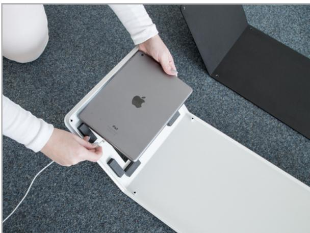
Abb. 3: Tablet einlegen und mit Kabel verbinden
