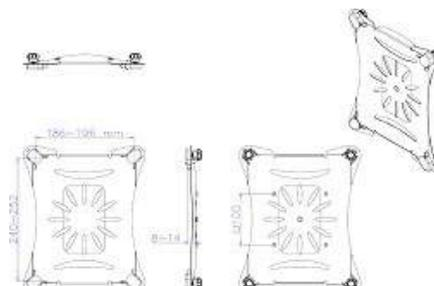
Mit diesem Universal-Tablet-Halter, die NewStar Modell TABLET-10, positionieren Sie eine Tablet auf den Schreibtisch, am Wand oder Decke durch Kombination mit einem VESA100x100 NewStar Halter. Diese Unterstützung sind leicht einstellbar, so dass alle denkbaren Positionen des Tablets möglich sind.
