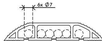
Addit Kabelschutz 300 cm 303
