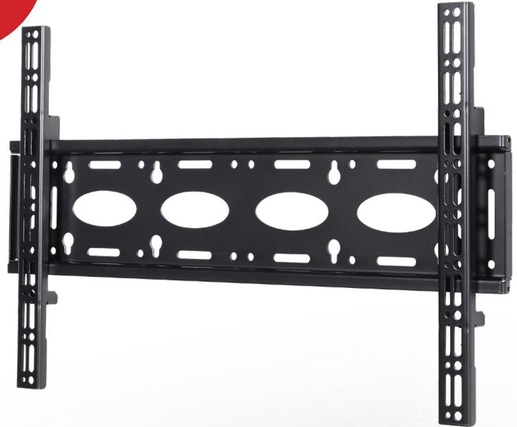
BT8442, für große Bildschirme entwickelt, trägt diese Halterung ein Gewicht bis zu 80 kg. Das flache Design ermöglicht die Montage der Bildschirme mit nur 30mm Abstand zur Wand. Mit universaler Befestigungsmöglichkeit für Montage Maße bis zu 656 x 400mm und Justierschrauben zur Nivellierung der Bildschirme, nachdem sie montiert wurden.
